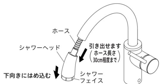
**【注意】** シャワーヘッドを引き出しすぎないでください。ホースが戻しにくくなったり、ホース損傷により漏水で家財などを濡らす財産損害発生のおそれがあります。
